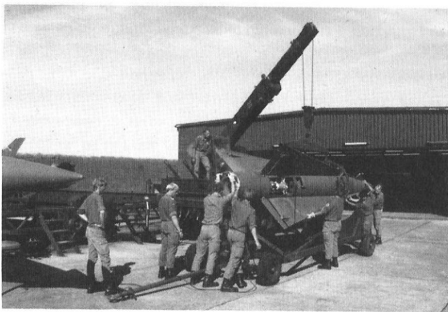
Demontage eines LFK's
